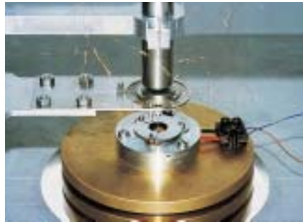
Microscope à effet tunnel: en dévoilant le comportement des atomes à la surface des conducteurs, ce microscope ouvre la voie vers la miniaturisation des composants électroniques.
